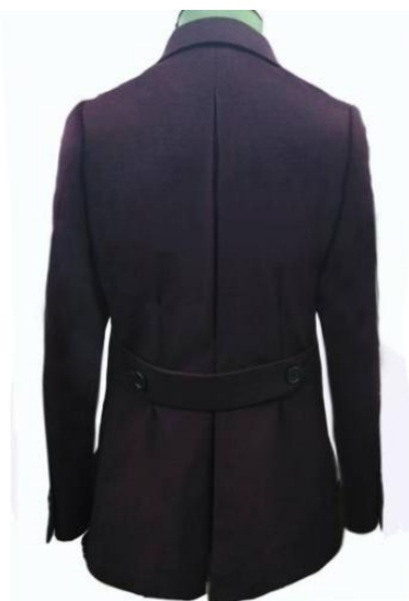
64V6 后背活折开衩(从后中领口下8CM至下摆), 加重叠宝剑头锁眼、钉扣腰袷, 后背左右腰部有活褶, 褶深0.5CM.
